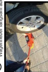
Unterstellbock entfernen, Wagenheber langsam ablassen.
